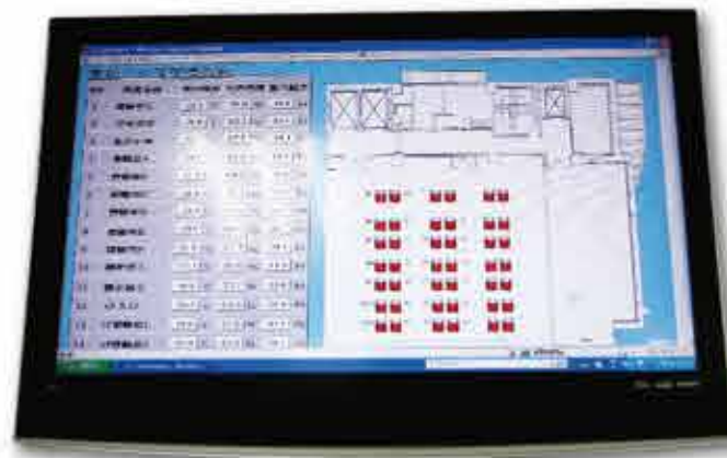
左圖：各壓力區，溫溼度監控。/ 右圖：細胞培養箱、儲存槽遠端監控。
