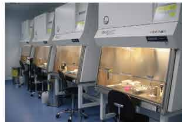
使用高級進口生物安全櫃，可同時保護細胞、操作者及環境的安全
